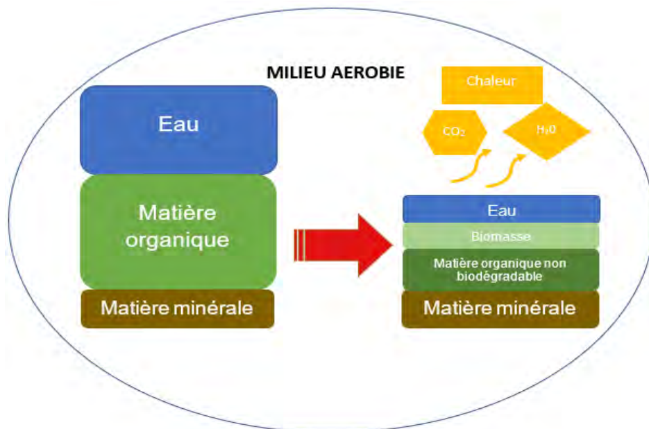
Figure 14: Schéma récapitulatif du processus de compostage.
