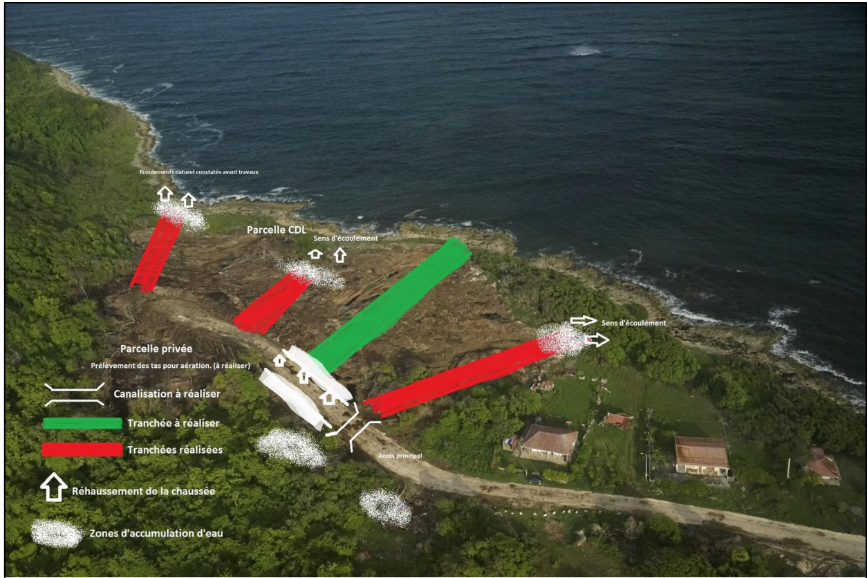
Illustration 9 : Aménagement du site (source : SIPS).
