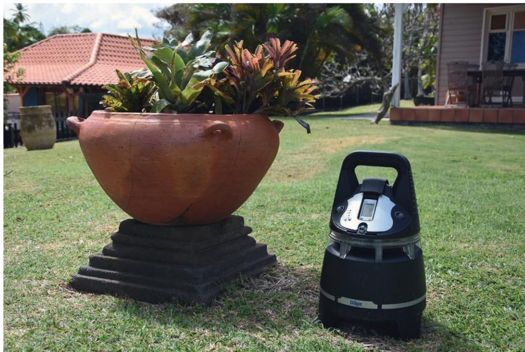
3. Ce capteur fixe posé par Madinainar et l'ARS, avec l'aide de l'Ademe, fait partie du réseau de capteurs fixes et mobiles implanté depuis 2015 pour mesurer au plus près des résidences les taux d'hydrogène sulfuré et d'ammoniac.
