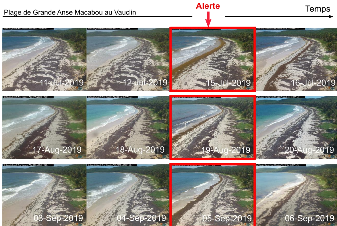
Illustration 31 : Series d'images illustrant l'efficacité du système sur la plage de Grande Anse Macabou au Vauclin d'alerte (3 derniers déclenchement sur la période de suivi). Le seuil d'alerte a été fixé à 4000 m 2 .
