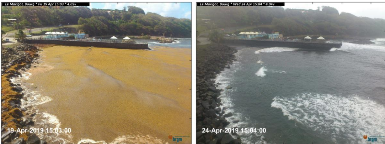
Illustration 18 : Séquence illustrant le renouvellement de la masse d'eau sur le site du bourg du Marigot suite à un épisode de vagues particulièrement énergétique le 24 avril 2019. La surface de sargasses estimée par l'algorithme réduit en quelques heures de plus de 3000 m 2 .
