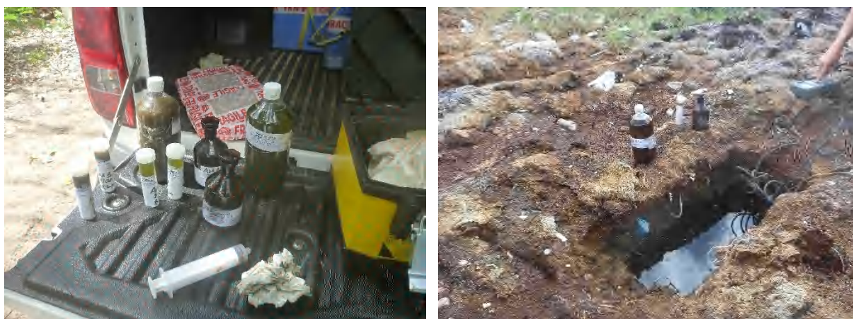
Illustration 3 : Flacons de prélèvements (gauche), mesure à l'aide de la sonde multi-paramètres sur une flaque de lixiviation à anse Maurice (droite)
