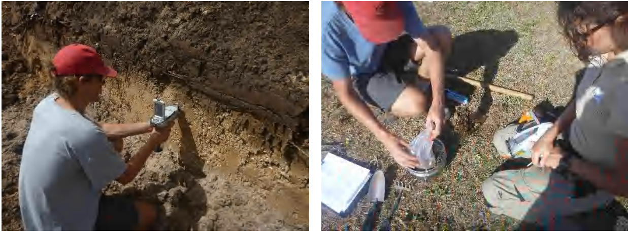
Illustration 4 : Mesure par pXRF à gros cap (gauche) et tamisage d'un sol à anse à la Bouelle (droite)
