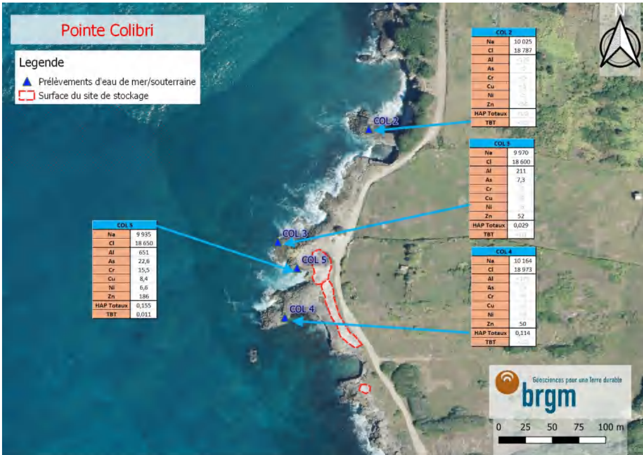
Illustration 41 : Carte des prélèvements d'eau de mer du site de stockage de Pointe-Colibri
