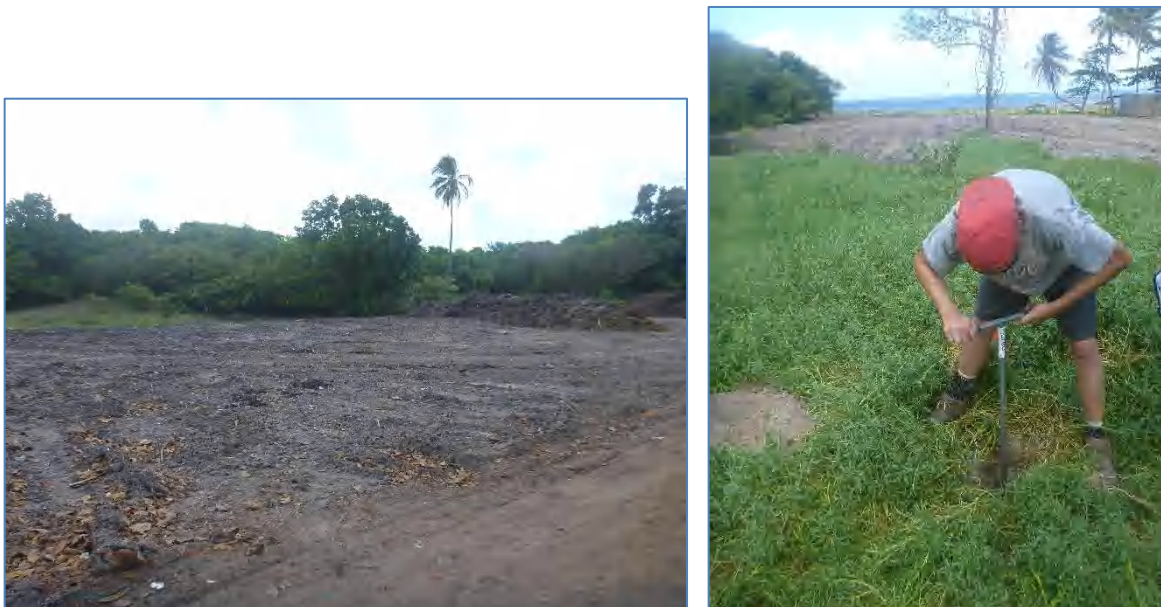
Illustration 24 : Vues du site de stockage de l'anse du Belley ; terrassement des dépôts (gauche) ; prélèvement du point BEL 03
