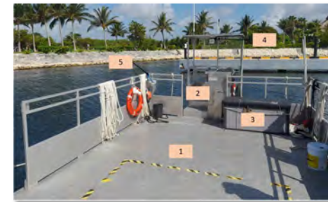
1 : Plateforme de stockage ; 2 : Zone de commande ; 3 : Coffre de rangement ; 4 : Lumière ; 5 : Ancre
