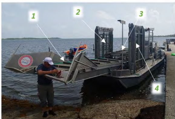
Figure 39 : SARGATOR II et ses tapis articulés (Source : SUEZ CONSULTING, Septembre 2021)
