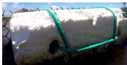
Figure 13 : Vue du barrage de Cap Est en août 2019 (à gauche) et état de décomposition des flotteurs polystyrène entre juin et septembre 2018 (à droite) (Source : SUEZ CONSULTING)
