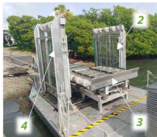
Figure 39 : SARGATOR II et ses tapis articulés (Source : SUEZ CONSULTING, Septembre 2021)
