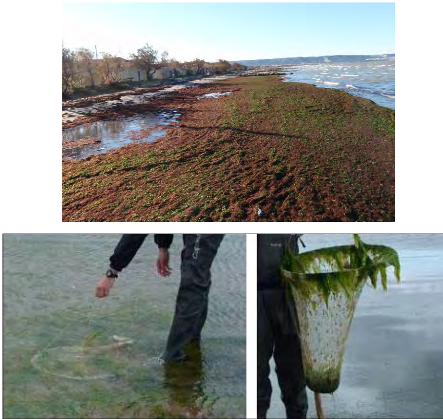
Figure 3: Illustration d'une mesure de biomasse sur plage à l'aide d'un quadra de 0.25 m 2
