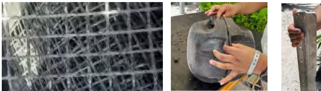
Figure 27 : Grillage structurel (à gauche), modules de flotteurs (au centre) et glissières raccords (à droite) (Source : SUEZ CONSULTING)
