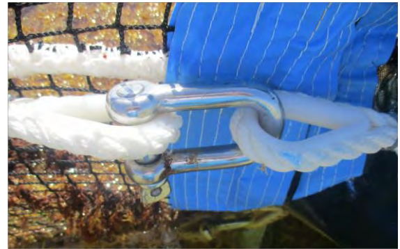
Manille permettant la fixation de deux modules
