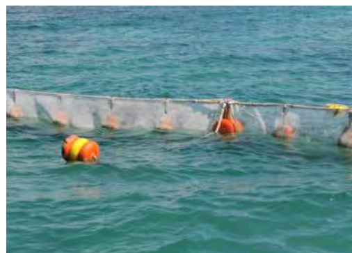
Figure 31 : Flotteurs (à gauche), Bouée d'ancrages et liaison (Source : SUEZ CONSULTING)
