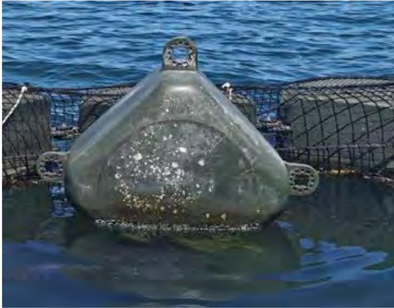
Figure 33 : CUBI SYSTEM "amortisseur" (Source : SUEZ CONSULTING)
