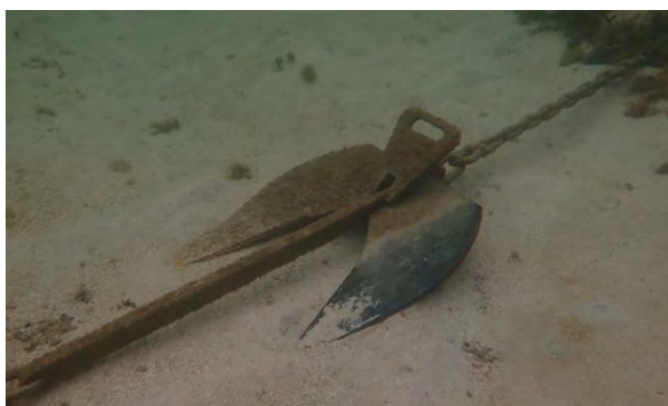
Figure 19 : Ancres de 50 kg assurant l'ancrage du barrage du Cap Est (Source : SUEZ CONSULTING)
