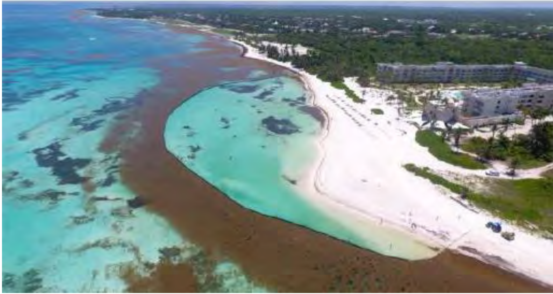
Figure 8 : Illustration d'un barrage à visée de confinement, en disposition fermée (Source : AlgeaNova, République dominicaine, Mai 2018)
