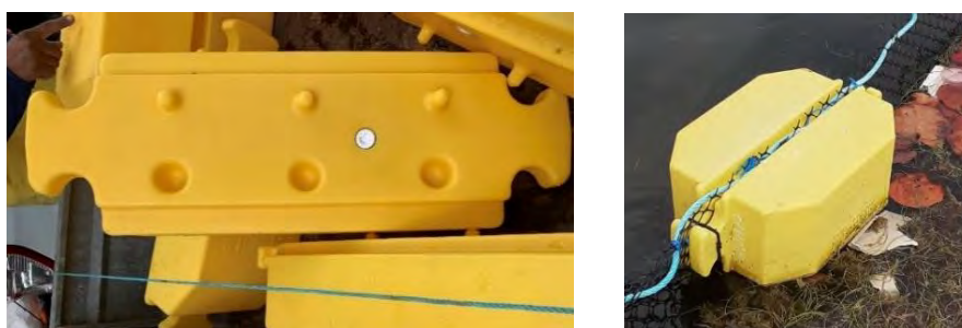
Figure 16 : Points d'accroche des flotteurs (à gauche) ; Flotteurs encastrés sur filet (à droite) (Source : SUEZ CONSULTING)
