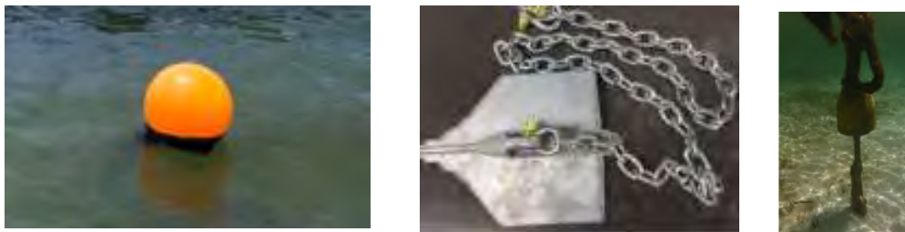
Figure 28 : Bouées de surface orange (à gauche), ancre type Manta ray (au centre) et ancrage (à droite) (Source : SUEZ CONSULTING)
