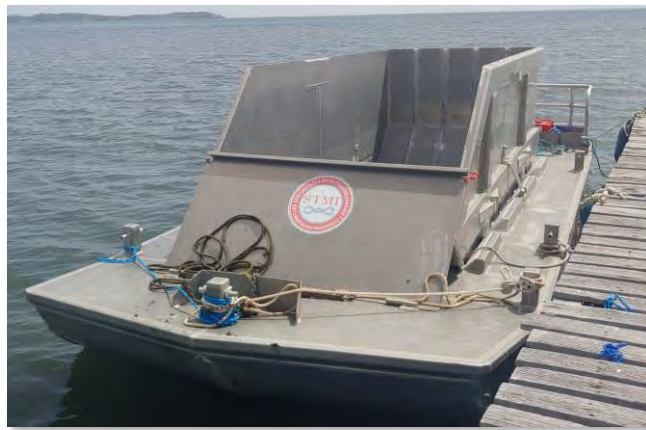
Figure 40 Barge-benne de déchargement des sargasses (Source : SUEZ CONSULTING, Septembre 2021)
