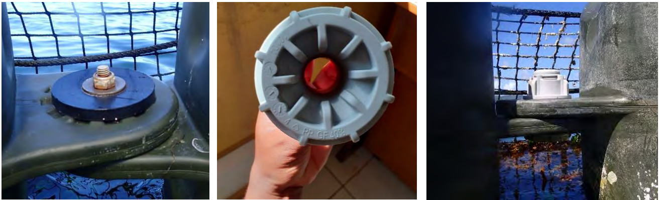
Figure 1 : Ancien composant en alliage métallique avec début de corrosion (à gauche), nouveau composant en PP GF 40% (au centre et à droite) du barrage CUBI SYSTEM©
